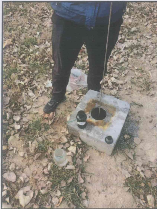
附图 3：厂区 3#监测井地下水采样
